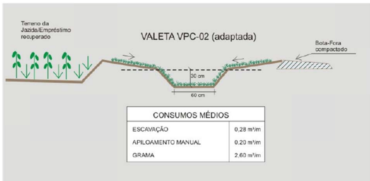
Figura 05 – Valeta de Proteção de Corte (VPC – 02).
